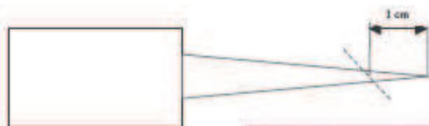
**Foro di estrusione circa 4mm. per controtelaio e/o spalle vano esterno**
