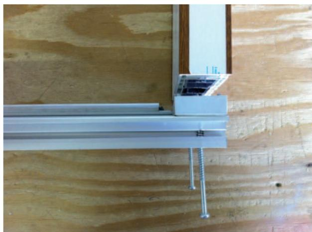
Prima di fissare la soglia ai montanti verticali del telaio è opportuno eseguire una buona sigillatura dei tappi in gomma in modo da evitare eventuali infiltrazioni, eseguire piccoli cordoli di silicone in modo che esso non fuoriesca con la pressione al momento del fissaggio.
