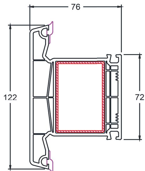
**Art. 102.357** - Traversa x battente da 76 mm
