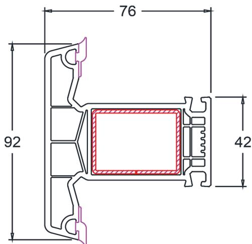
**Art. 102.352** - Traversa x battente da 76 mm
