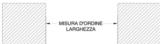
Per il rilievo delle misure esecutive vanno indicate sempre le misure luce foro piene avendo l'accortezza di indicare quella più stretta, le tolleranze verranno date automaticamente come riportato negli schemi riportati a fianco.
