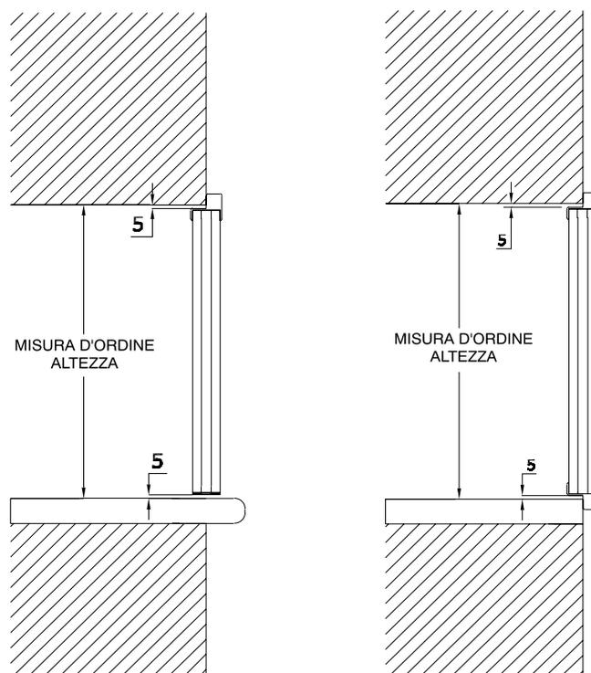
Per il rilievo delle misure esecutive vanno indicate sempre le misure luce foro piene avendo l'accortezza di indicare quella più stretta, le tolleranze verranno date automaticamente come riportato negli schemi riportati a fianco.
