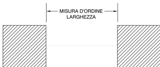
Per il rilievo delle misure esecutive vanno indicate sempre le misure luce foro piene avendo l'accortezza di indicare quella più stretta, le tolleranze verranno date automaticamente come riportato negli schemi riportati a fianco.
