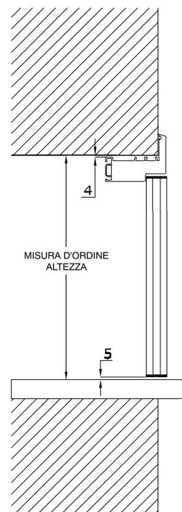
Per il rilievo delle misure esecutive vanno indicate sempre le misure luce foro piene avendo l'accortezza di indicare quella più stretta, le tolleranze verranno date automaticamente come riportato negli schemi riportati a fianco.
