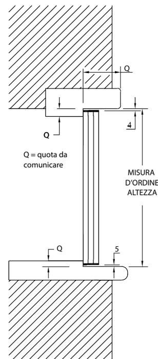
Per il rilievo delle misure esecutive vanno indicate sempre le misure luce foro piene avendo l'accortezza di indicare quella più stretta, le tolleranze verranno date automaticamente come riportato negli schemi riportati a fianco.
