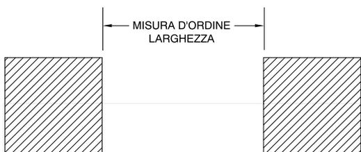
Per il rilievo delle misure esecutive vanno indicate sempre le misure luce foro piene avendo l'accortezza di indicare quella più stretta, le tolleranze verranno date automaticamente come riportato negli schemi riportati a fianco.
